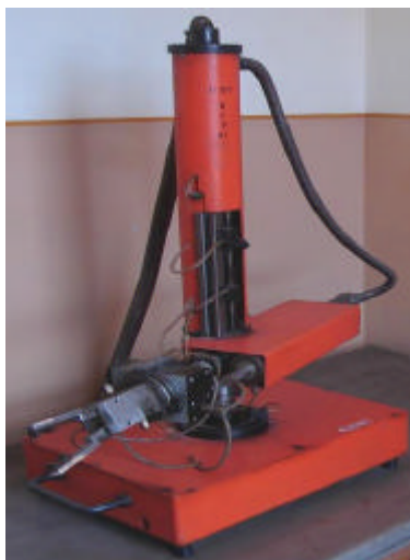
Fig. 4 Robotul în coordonate cilindrice 1R, 2T
